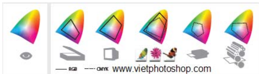
Dải màu trông thấy chứa hàng triệu màu (bên trái) so với các gam màu của các thiết bị
